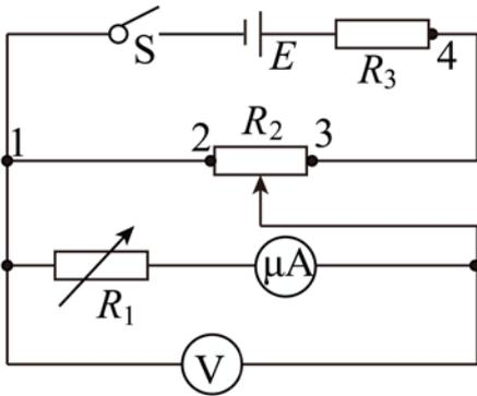
(1) 微安表铭牌标示内阻为  $0.8\text{k}\Omega$ , 据此计算  $R_1$  的阻值应为 \_\_\_\_\_  $\text{k}\Omega$ 。按照电路图连接电路, 并将  $R_1$  调为该阻值。
